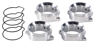
JB-POWER アルミ削り出しパワーフィルター アダプター (Oリング付属)
